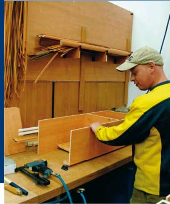
I snedkeriet samles de forskellige elementer til overskabene, før de på samlebåndet monteres i vognene.
