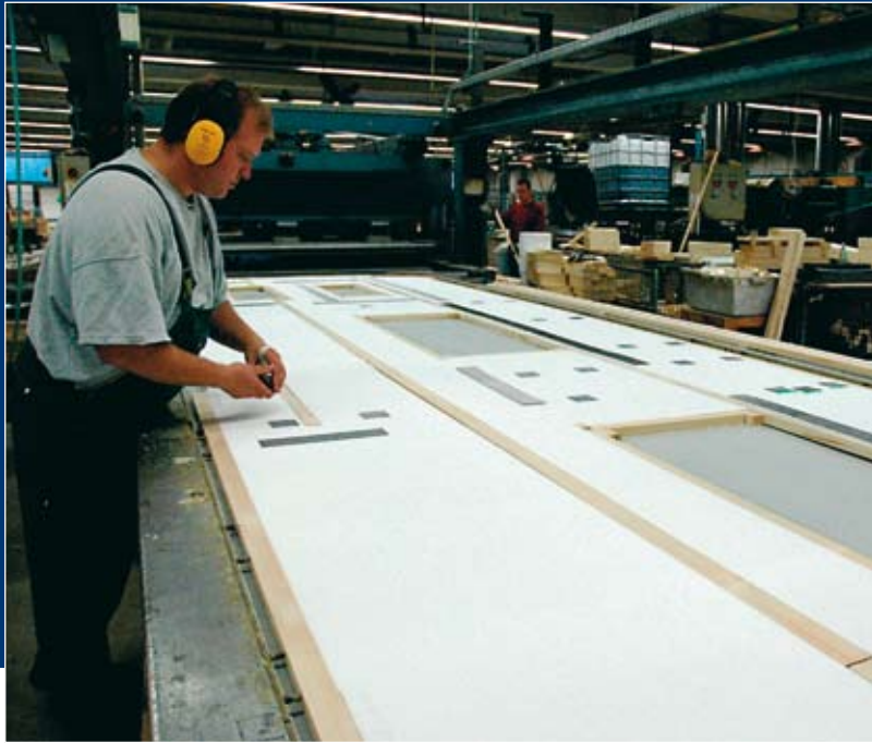
En vognside bygges op. De små, grå flader er små alu-netplader, der skal fungere som forstærkning ved vægmontering af møbelementer.
