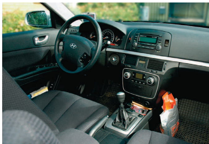
En rigtig god arbejdsplads med overskuelige, logisk placerede instrumenter. Det lille, ovale instrument foran gearstangen er betjeningspanelet til Webasto motorvarmeren.
